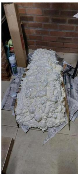
**Figura 7** – Aplicação de Espuma Expansiva no Molde
