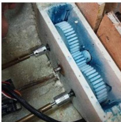
**Figura 18** – Vista isométrica da caixa de transmissão
