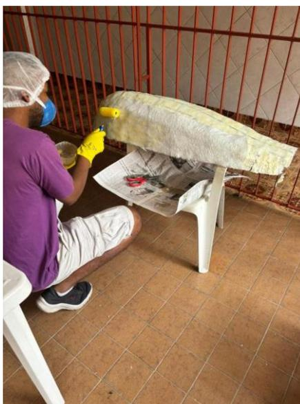
**Figura 9** – Aplicação de Fibra de Vidro e Resina
