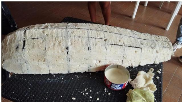
**Figura 8** – Espuma expansiva cortada no formato do molde
