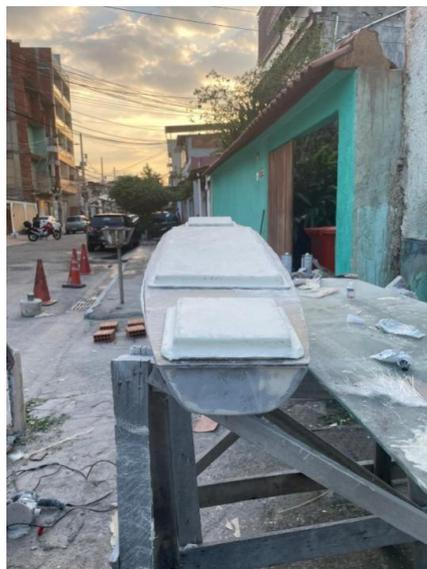
**Figura 10** – Embarcação Emassada
