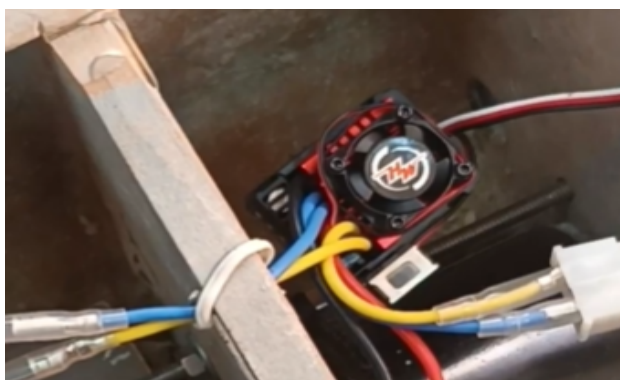
Figura 7 – ESC Hobbywing Quicrun 880 que perdeu \frac{1}{4} da sua capacidade durante os testes
