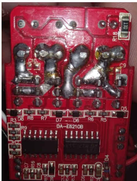
Figura 6 – Trilha comprometida do ESC 320A N/traxxas
