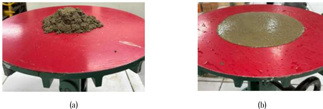
**Figura 2.** (a) Consistência da argamassa REF. (b) Consistência da argamassa M100%.
