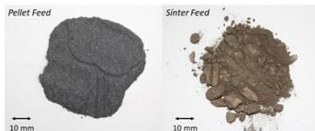
**Figura 1.** Materiais utilizados nos ensaios: Pellet feed (esquerda) e Sinter feed (direita).
