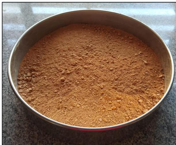
**Figura 1.** Resíduo cerâmico utilizado na produção das argamassas
