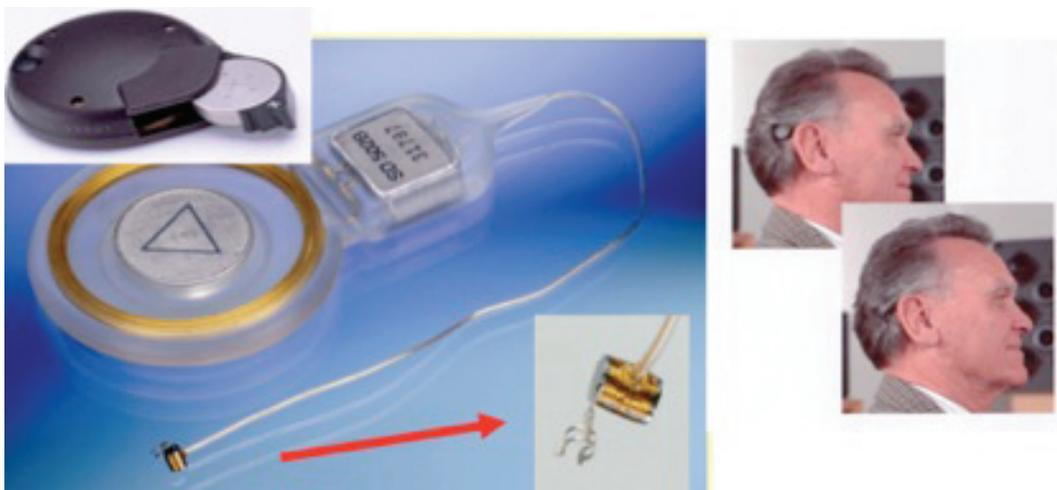
Figura 5: Implante Auditivo de Orelha Média com sua porção interna e externa.
