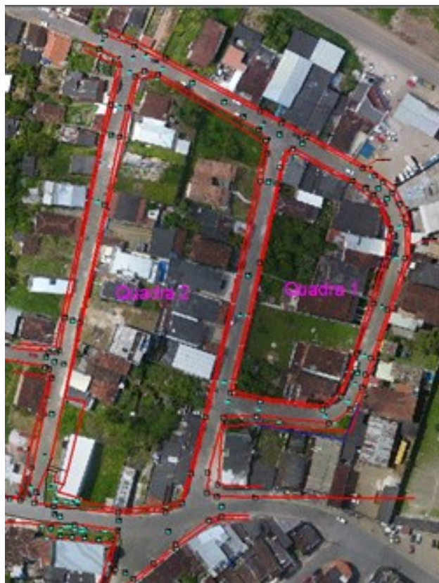
Figura 10 – Sobreposição do Levantamento Topográfico Convencional ao Ortomosaico Gerado pelo Levantamento com RPA
