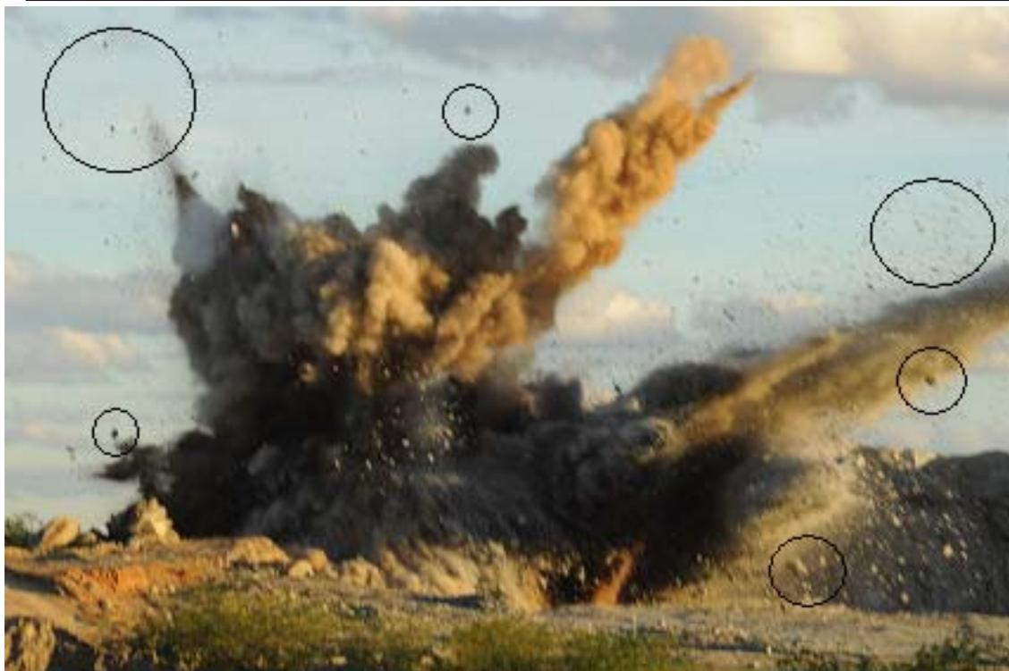
**Figura 3:** Ultralaçamento proveniente do desmonte de rocha com explosivos
