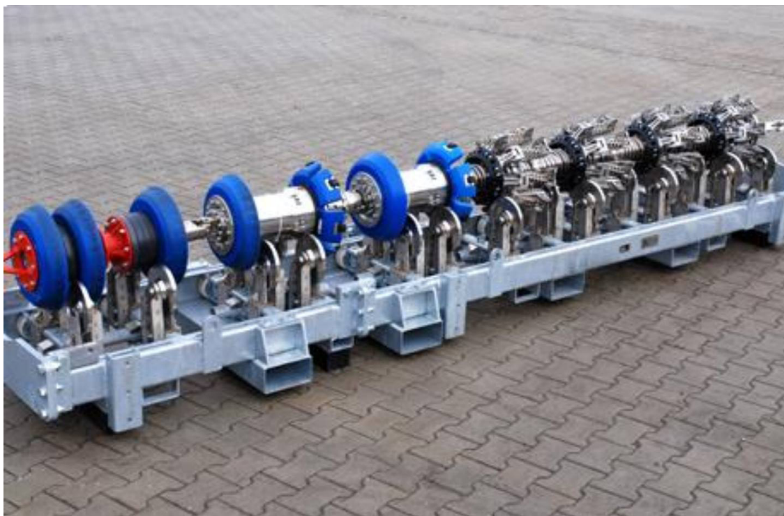
FIGURA 4: PIG de monitoramento de mineroduto:
