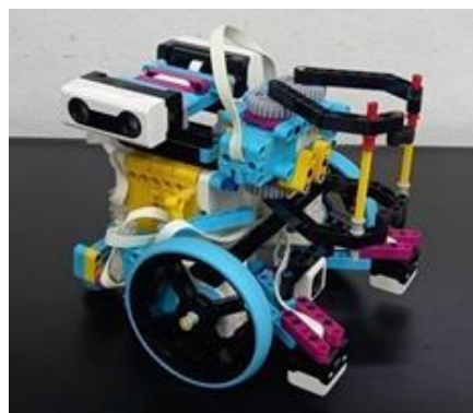
Figura 7 — Carro autônomo para a categoria Challenge SEK
