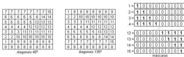
**Figura 7. Os dois tipos de vetores auxiliares.**
