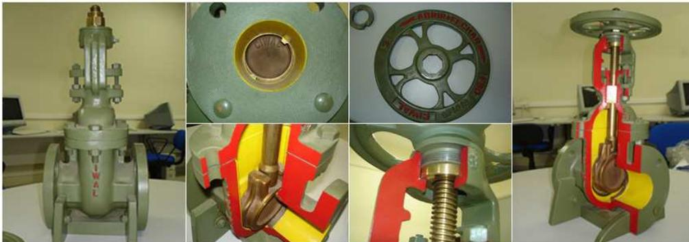
**Figura 3. Fotos tiradas do equipamento *válvula gaveta* para a obtenção de informações.**
