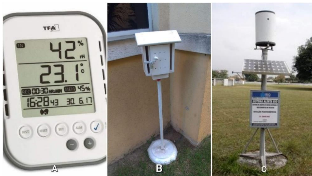
Figura 3. A- Equipamento datalogger de temperatura e umidade do ar TFA KLIMALOGG PRO Thermo-Hygro-Logger. B – Abrigo de madeira branco com furos nas laterais a 1,5 metros de altura. C- Estação meteorológica de Santa Cruz.
