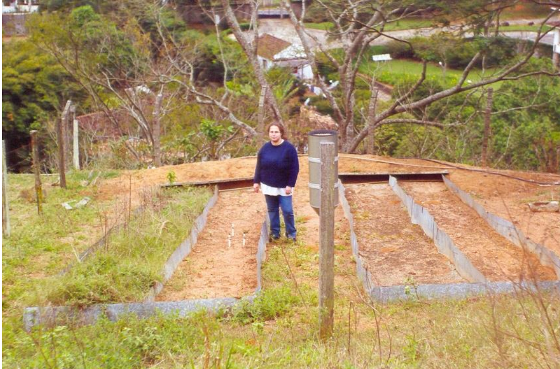
Figura 10. Estação experimental montada na Fazenda Marambaia, Petrópolis (RJ), para monitorar perda de solo e água.
