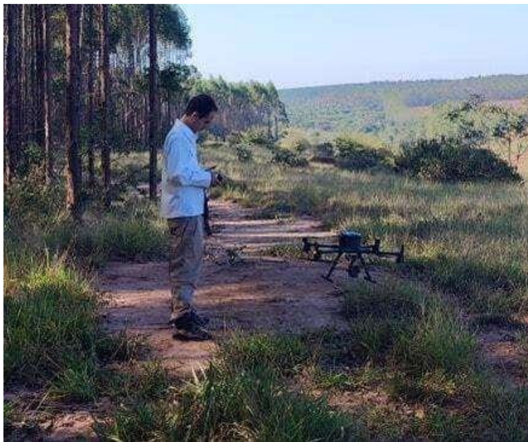
Figura 10. Utilização do drone e LiDAR em campo.
