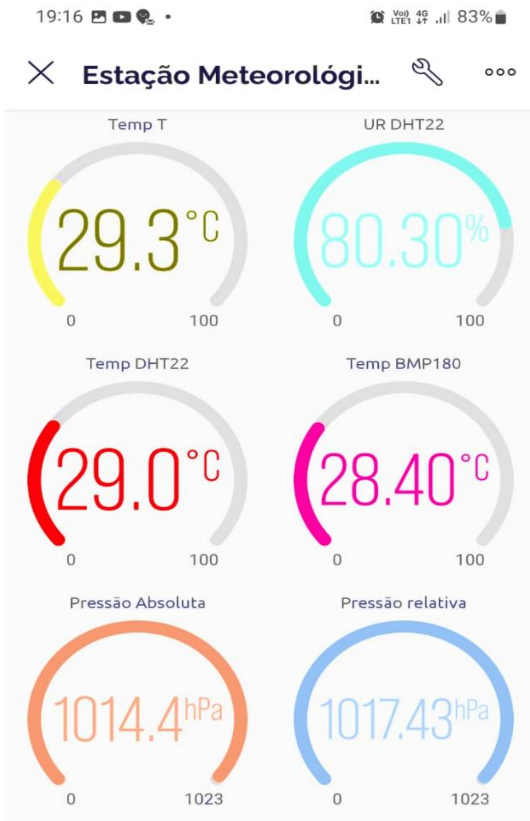
Figura 5: Interface no aplicativo Blynk mobile pelo sistema Android para o monitoramento em tempo real da temperatura e umidade relativa do ar e pressão atmosférica
