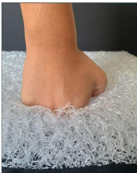
Figura 1: Malla de tecnología C-CORE, compuesta de copolímero de etileno-1-octeno (elastómeros). Belo Horizonte, MG, Brasil, 2024.
