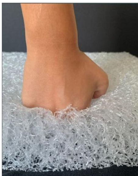
Figura 1: Manta da tecnologia C-CORE, composta por copolímero de etileno-1-octeno (elastômeros). Belo Horizonte, MG, Brasil, 2024.
