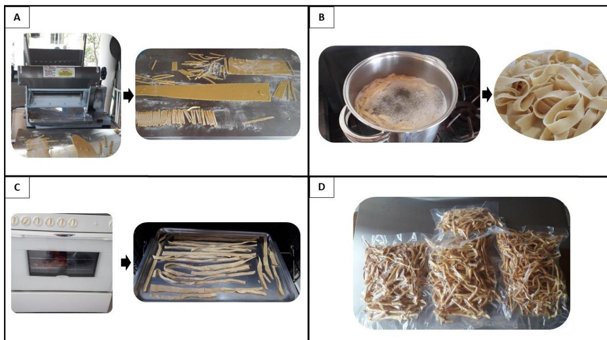
**A:** Cilindramento e modelamento da massa; **B:** Intantaneização do macarrão; **C:** Secagem do macarrão; **D:** Macarrão em embalagem a vácuo para armazenamento.
