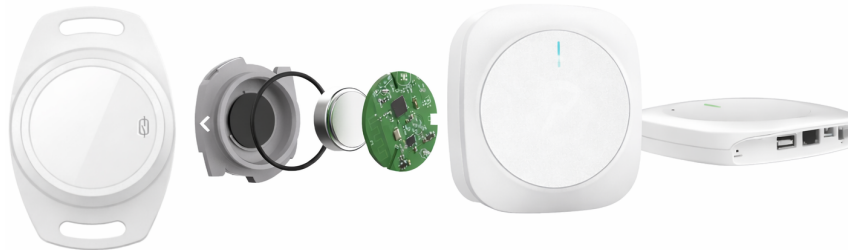
Figura 1. À esquerda temos nó o emissor, no centro o seu interior e à direita o nó sensor
