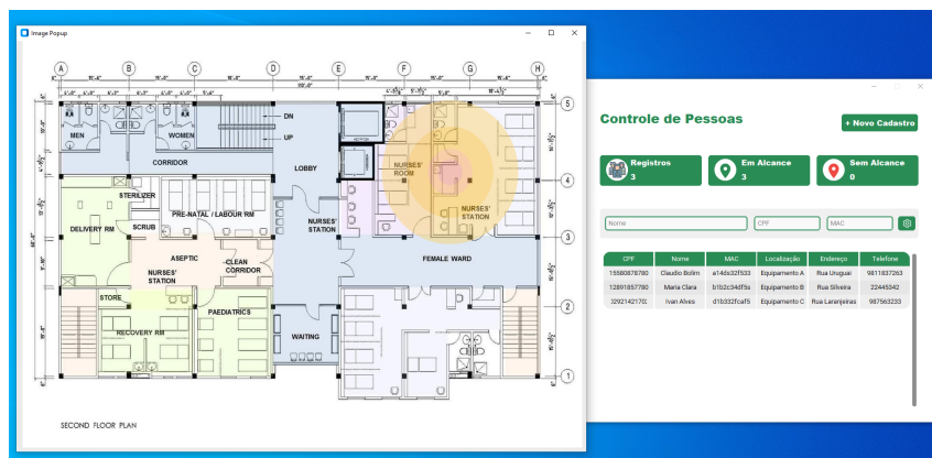
Figura 14. Planta demonstrando que o MAC consultado se encontra ao alcance entre -80 dBm e -60 dBm do sensor. Indicando afastamento do dispositivo
